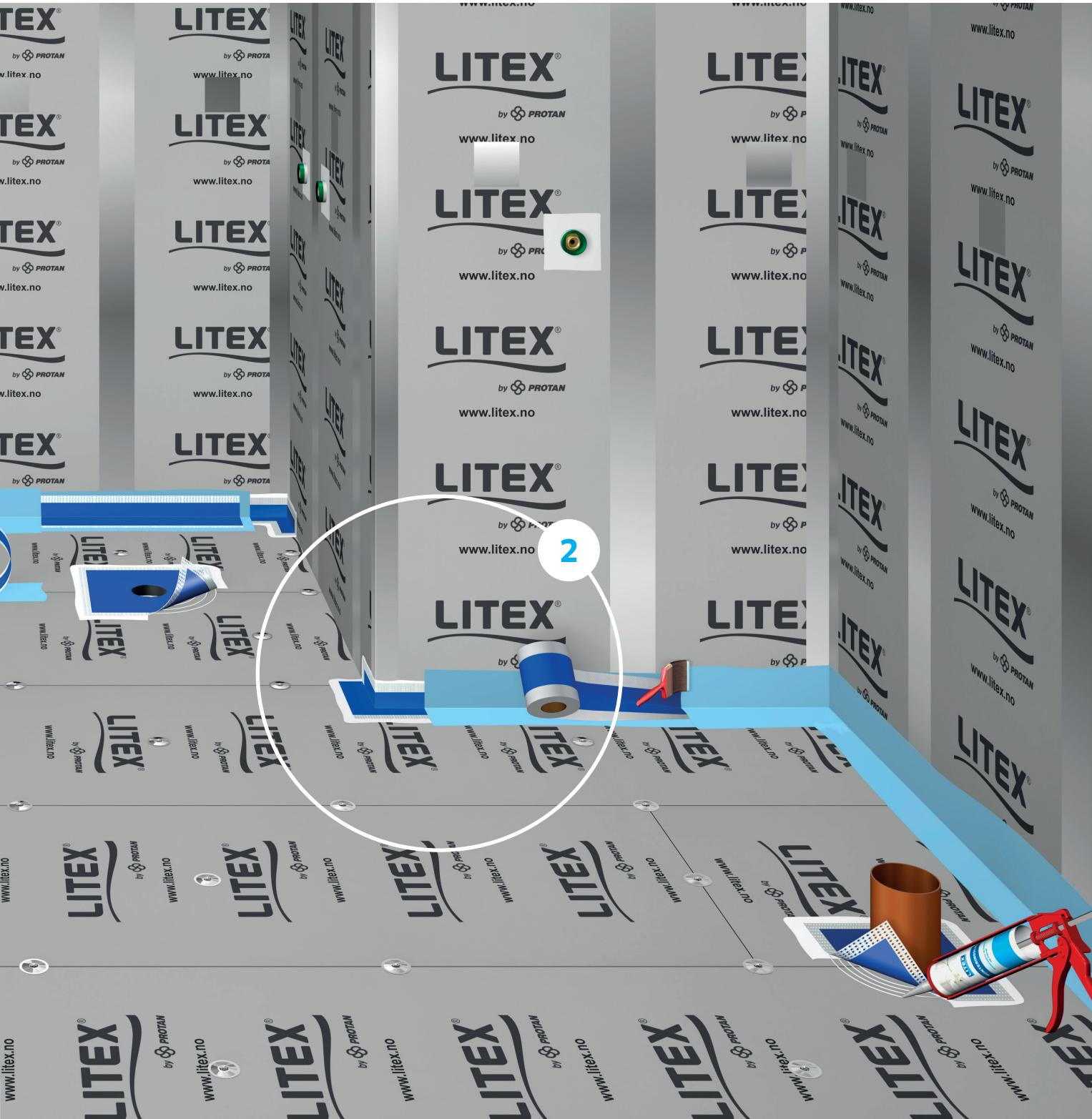
**1** Varmekabler med inntil 10W per løpemeter kan monteres direkte på membranplatene. Varmekabler over 10W per løpemeter må monteres på et armeringsnett som hever kabelen minimum 5 mm fra platene. Varmekabler monteres i henhold til produsentens anvisninger. Litex anbefaler påstøp som tåler vann og må legges i minimum 20 mm tykkelse. Støpermasse brukes i henhold til produsentenes anvisninger. Ved bruk av påstøp som ikke tåler vann må gulvet heldekkes med membran før flislegging.
