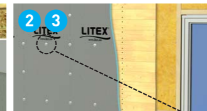
Schraubverbände mitten auf der Platte können auch stellenweise durch Leim ersetzt werden, so dass nur die Nähte abgedichtet werden müssen.
