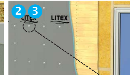
Mocowania śrub pośrodku płyty można alternatywnie zastąpić klejeniem punktowym; wtedy należy uszczelnić tylko łączenia.
